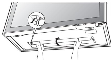
**3** 蛍光管を差し込み蛍光管口金部のへこみと蛍光管ソケットのきりかき合うまで蛍光管を回転させて取り付けます。
