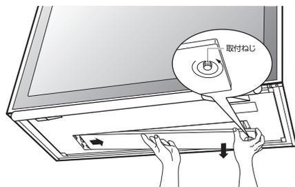
**2** 蛍光管を回転させて下側にはずします。
